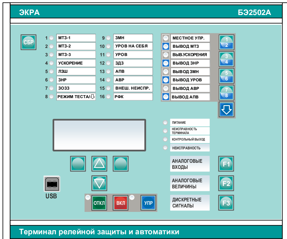
Рисунок 6.4 - Расположение элементов на лицевой панели терминала БЭ2502А0303
